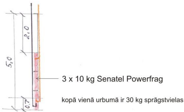
4.attēls. „Sprādziena 1” urbumu izvietojuma shēma un sprāgstvielu izvietojums urbumā
