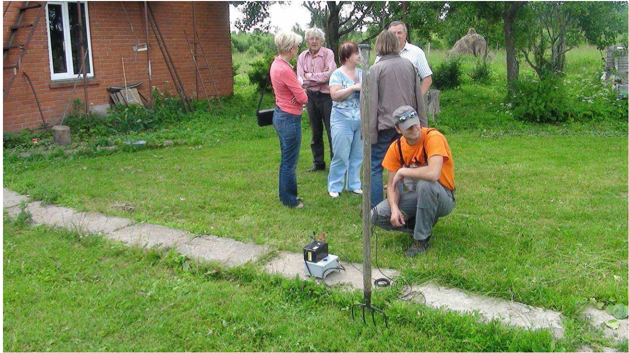
2.attēls. Karjera spridzināšanas laikā izraisīto svārstību mērījumi viensētā N1.
