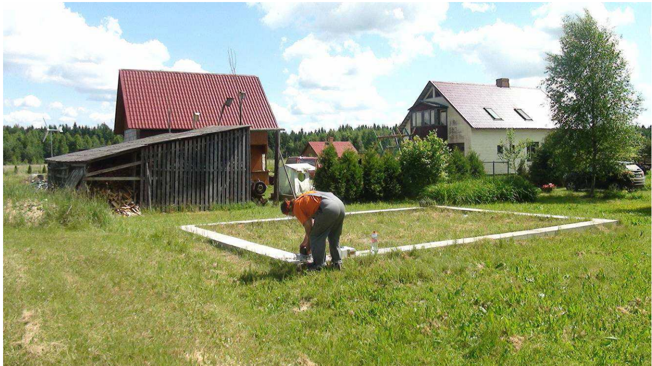
3.attēls. Karjera spridzināšanas laikā izraisīto svārstību mērījumi viensētā N2.
