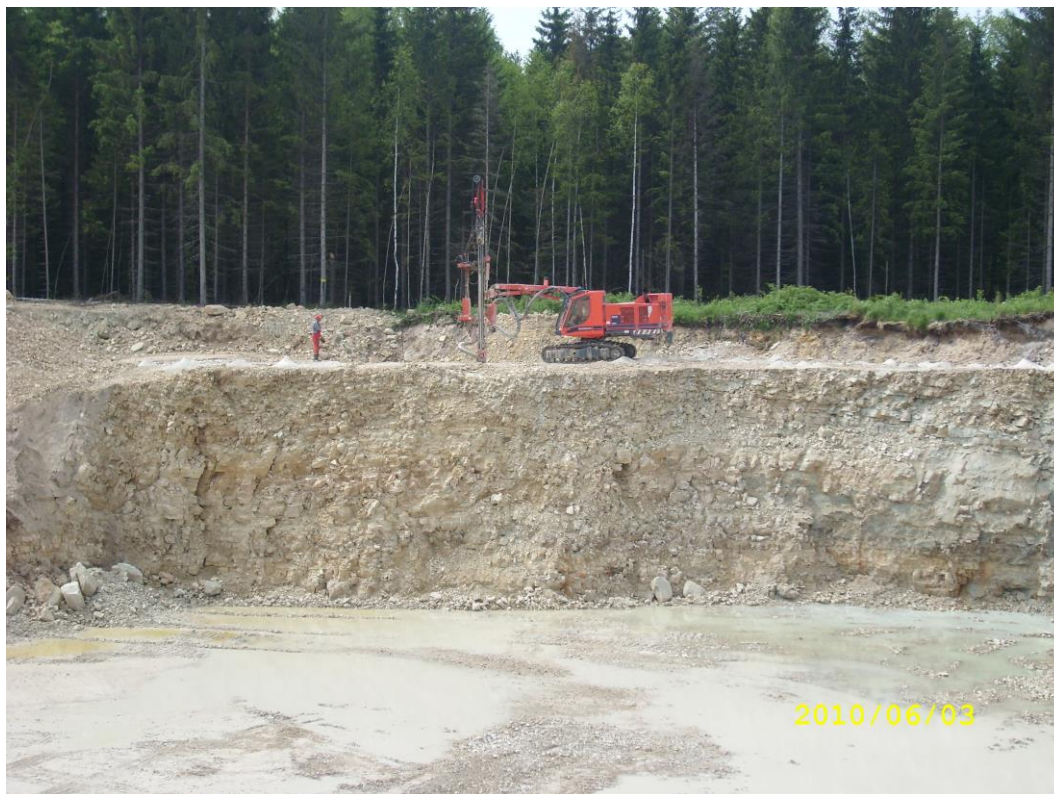
3.7. attēls. Spridzināšanas urbuma ierīkošana augšējā ieguves kāplē (agregāts Tamrock Ranger 800)
